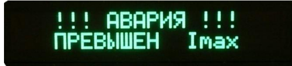
Рисунок 6. Экран дисплея при отображении аварий генератора.
