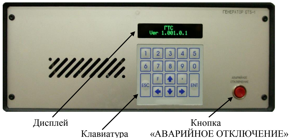
Рисунок 2. Внешний вид передней панели генератора.
