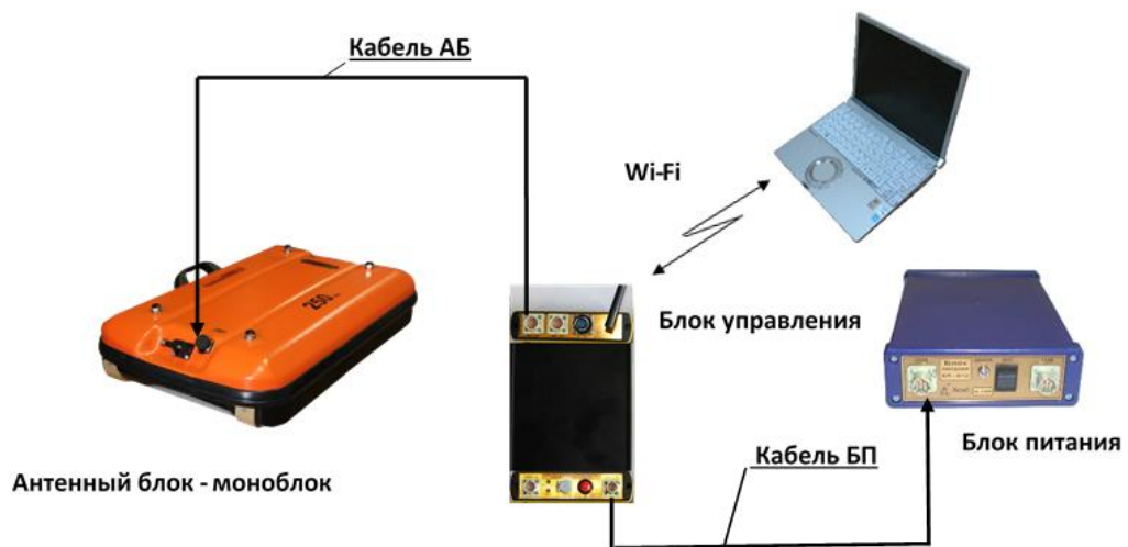
Рис. 2.9 - Схема соединений георадара с универсальным базовым комплектом и моноблоком (передача данных по каналу Wi-Fi)
