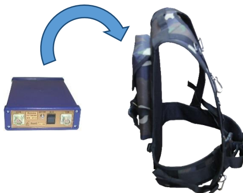
Рис. 2.3 - Размещение блока питания БП-9/12 в ременно-плечевой системе
