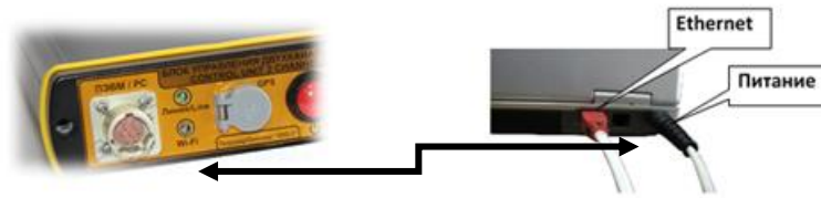
Рис. 2.5 - Подключение между блоком управления и ноутбуком кабелем ПЭВМ
