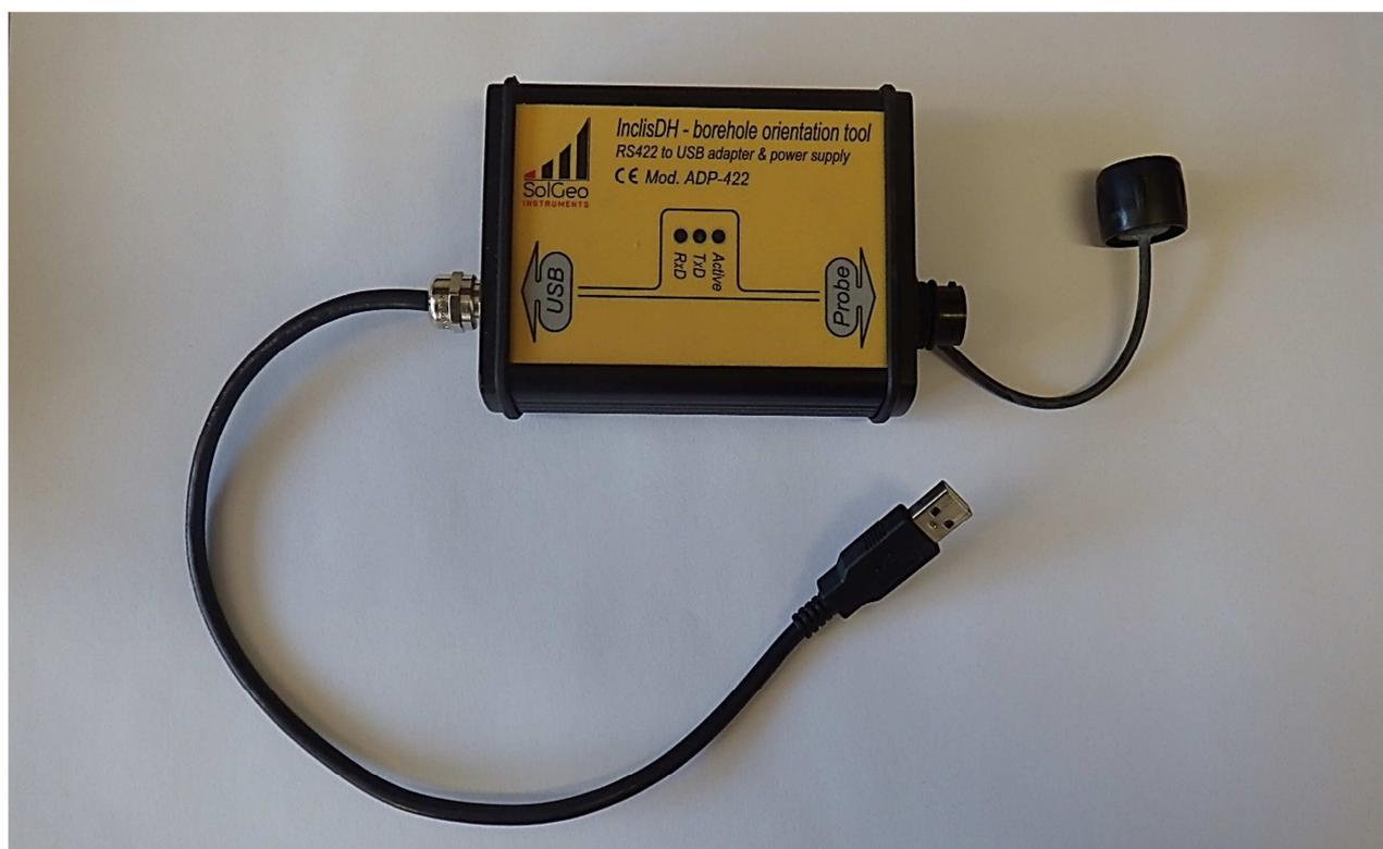
*Illustration 4: box di interfaccia tra PC e sonda INCLISDH*
