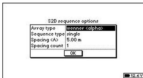
Это первый из экранов с настройками создаваемого шаблона S2D. Часть параметров (Array type, Sequence type, MN count) устанавливается при помощи циклического переключения, а другая (Spacing <a>, First electrode) требует цифрового набора на клавиатуре. Для перехода в следующее меню нужно установить курсор на кнопку ОК и нажать Enter.
