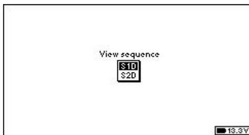
В этом меню можно выбрать тип шаблона для просмотра. S1D используется для работы в режиме Manual, а S2D – в режиме Automatic. Описание режимов работы аппаратуры находится в разделе “Режимы работы”.
