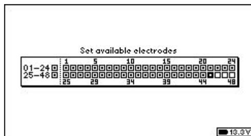
Это меню используется для включения и отключения электродов и кабелей при работе в режиме Automatic. Измерительные установки, в состав которых входят отключённые электроды, будут пропускаться в процессе работы. По умолчанию используются оба кабеля со всеми электродами. Изменения сохраняются только на время текущей работы; при следующей работе в режиме Automatic будут восстановлены параметры по умолчанию, даже если работа ведётся с тем же файлом данных.
