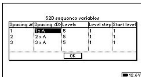
Это второй из экранов с настройками создаваемого файла шаблонов S2D. Все параметры на этом экране набираются на клавиатуре. Для перехода в следующее меню нужно установить курсор на кнопку ОК и нажать Enter.
