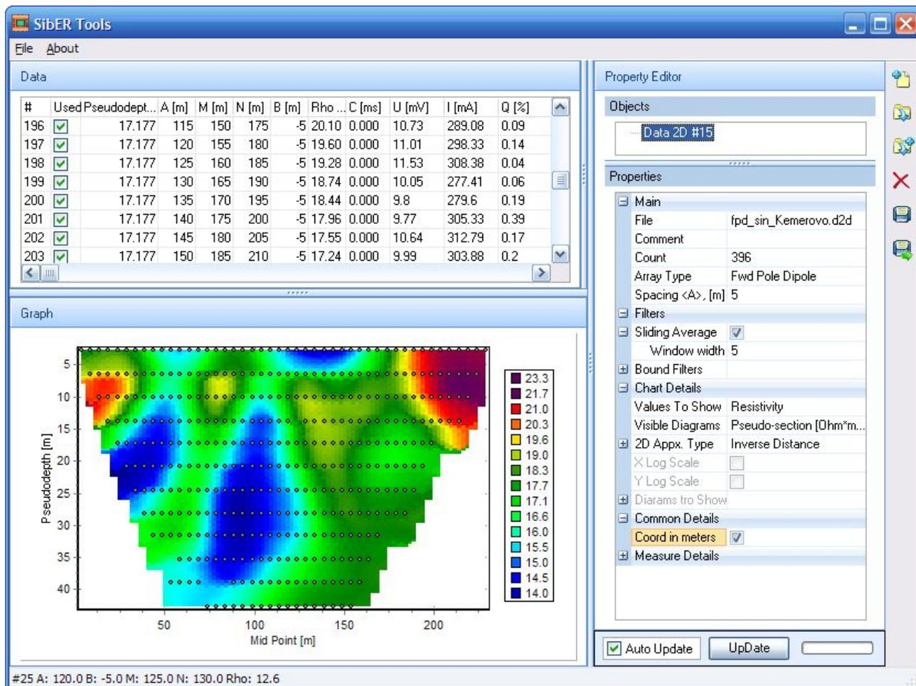
Кроме того, в реестре свойств появятся органы управления панелью визуализации (Chart Details). Опции X Log Scale и Y Log Scale в разделе Chart Details позволяют делать масштабы осей графика логарифмическими. Выбирая значение для параметра Visible Diagrams из Pseudo-section, All Sounding Curves, All Profile Curves и Signal Diagrams, на панели визуализации можно соответственно отображать:
