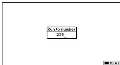
Чтобы при работе быстро устанавливать указатель текущего измерения на нужную позицию, можно вводить её номер в этом окне. Значения, выходящие за пределы допустимых, будут приводиться к граничным значениям.
