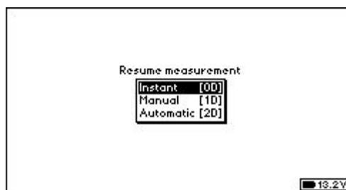
Данный режим предназначен для возобновления незаконченной работы. Сначала система предложит установить параметры измерения (см. *Measure - Options*), после чего будет предоставлена возможность выбрать вид работ, который требуется продолжить.
