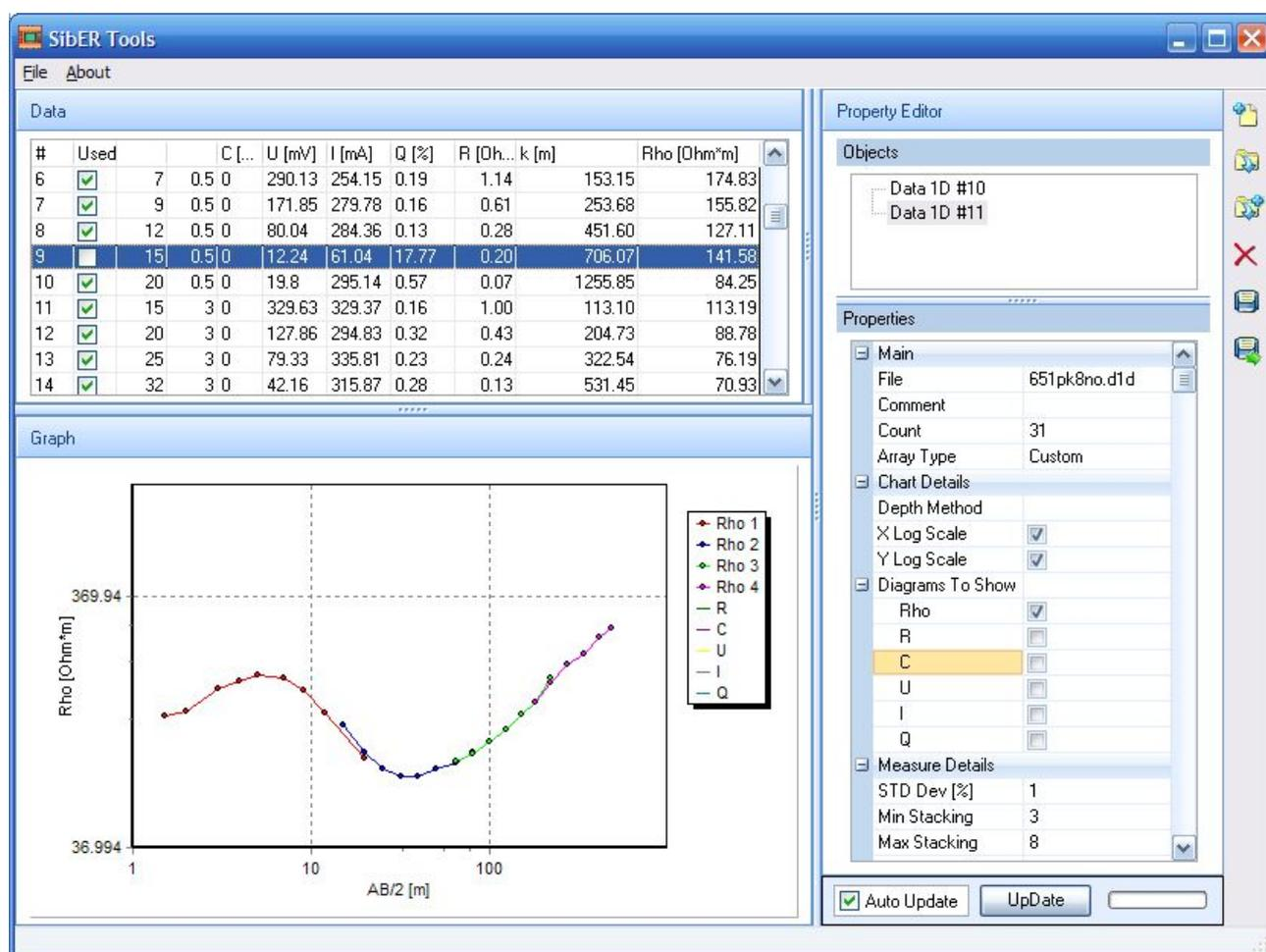
В таблице данных будет показана следующая информация о содержащихся в файле измерениях: номер измерения (#), два характерных расстояния для использованного типа измерительной установки (P.1 и P.2, м), кажущаяся поляризуемость (C, мс), входное напряжение (U, мВ), выходной ток (I, mA), относительное отклонение (Q, %), электрическое сопротивление (R, Ом), геометрический коэффициент установки (k, м), кажущееся удельное электрическое сопротивление (Rho, Ом·м).
