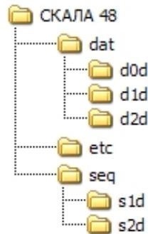
В каталогах /dat/d0d, /dat/d1d, /dat/d2d содержатся файлы данных D0D, D1D и D2D соответственно. Файлы D0D используются при работе в режиме Instant, D1D – в режиме Manual, D2D – в режиме Automatic (см. “Режимы работы”).
