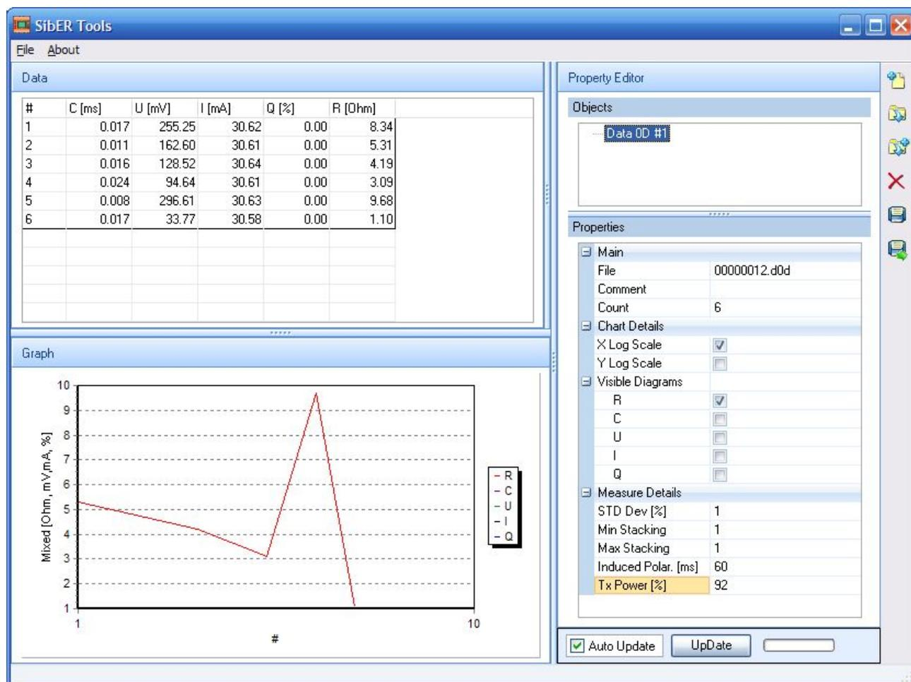
В реестре свойств объекта будет отображена следующая информация о файле данных: во вкладке Main — имя файла (File), комментарий (Comment) и число измерений (Count), а во вкладке Measure Details — параметры прибора, с которыми были выполнены измерения. Опции X Log Scale и Y Log Scale в разделе Chart Details позволяют делать масштабы осей графика логарифмическими.
