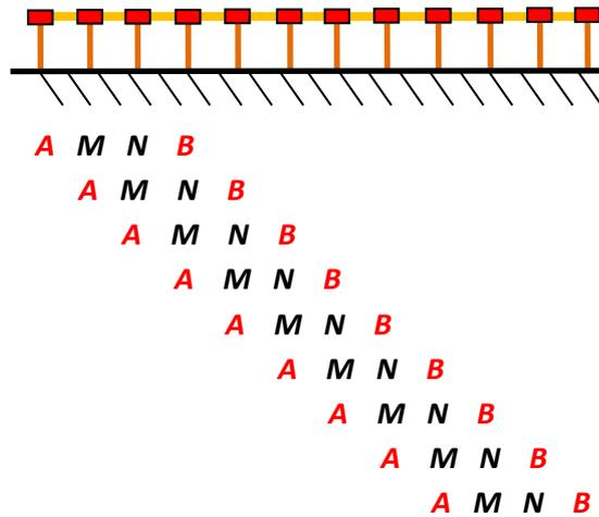
Набор установок, входящих в схему наблюдений, можно охарактеризовать, перечисляя номера электродов, соответствующих питающим (A, B) и измерительным (M, N). Каждой установке в наборе соответствует уникальное сочетание A, B, M, N.
