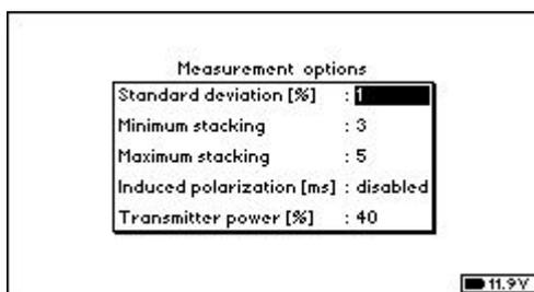
Здесь настраиваются параметры генератора и измерителя. Установки в дальнейшем сохраняются. При возникновении проблем с системными файлами (см. “Предупреждения”) будут восстановлены настройки по умолчанию.
