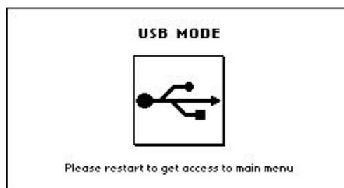
Для синхронизации необходимо соединить прибор с компьютером при помощи USB—кабеля (входит в комплект аппаратуры). Внутренняя память прибора распознаётся как внешний накопитель. Структура каталогов внутренней памяти прибора описана в разделе “*Структура каталогов аппаратуры “СКАЛА 48”*”. Для дальнейшей работы с прибором требуется перезагрузка (выключение и включение).
