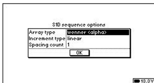
Это первый из экранов с настройками создаваемого шаблона S1D. Все параметры устанавливаются при помощи циклического переключения. Для перехода в следующее меню нужно установить курсор на кнопку ОК и нажать Enter.
