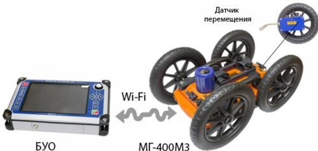
Рис. 2.4 - Соединение БУО с антенным блоком через Wi-Fi интерфейс
