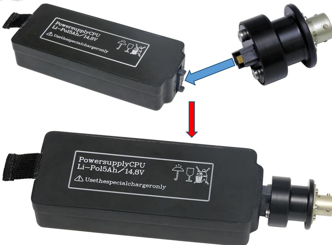
Рис. 1.5 - Соединение БП и устройства контактного
