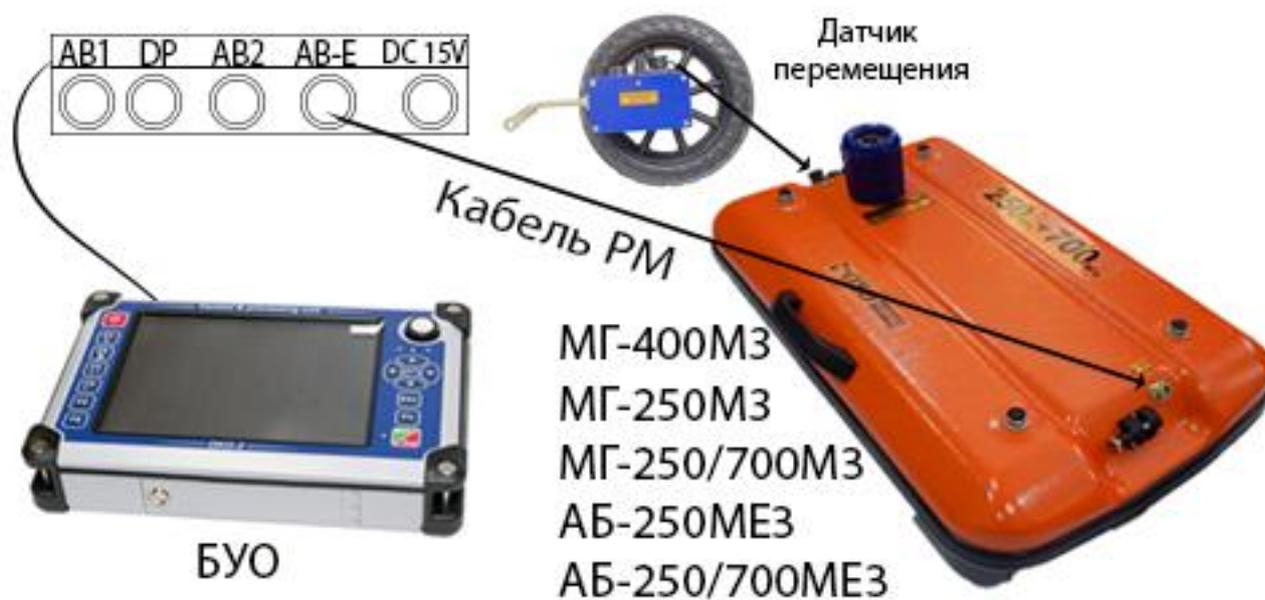
Рис. 2.2 - Соединения БУО с одной антенной посредством РМ кабеля
