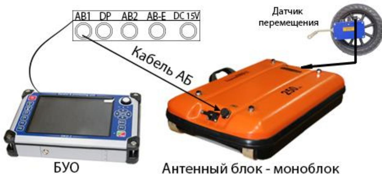
Рис. 2.1 - Схема соединения БУО с одной антенной посредством кабеля АБ
