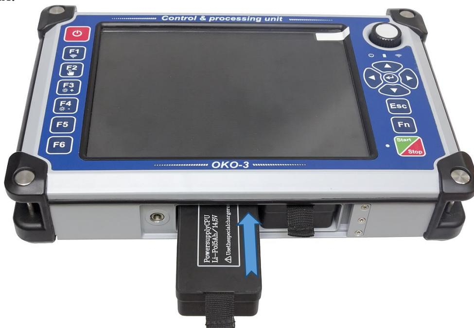
Рис. 1.8 - Установка батарей
