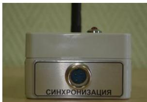
Рис. 7. Расположение разъема синхронизации.
