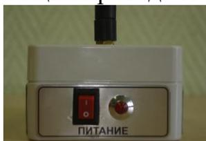
Рис. 6. Расположение выключателя питания.
