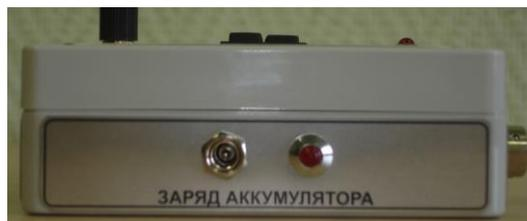
Рис. 4. Расположение разъема для заряда аккумулятора и индикатора.
