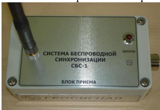
Рис. 8. Расположение антенны и индикаторов запуска.
