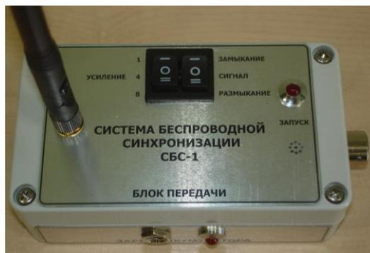
Рис. 5. Расположение антенны, переключателя и индикаторов запуска.
