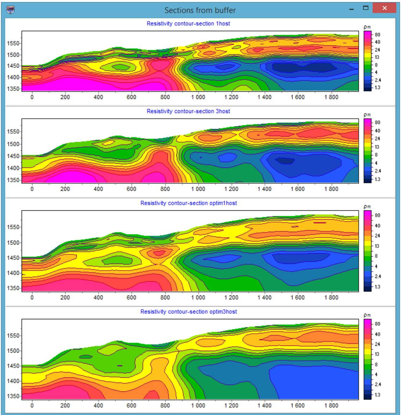
Рис. 7 Пример отображения нескольких моделей через окно Buffer
