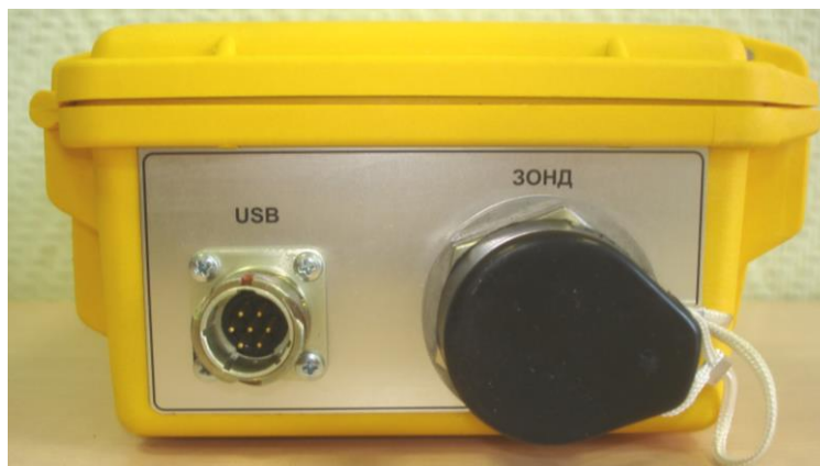
Рис. 3. Расположение разъемов для подключения зонда и USB порта компьютера на интерфейсе ТЕЛСС-ВСП.
