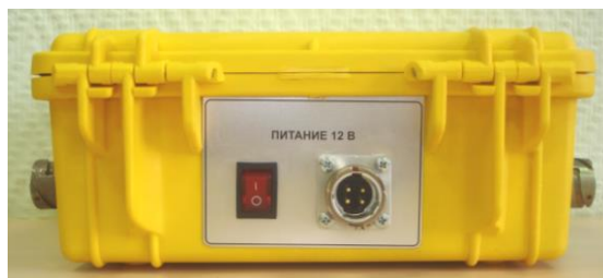
Рис. 2. Расположение разъема для подключения питания на интерфейсе ТЕЛСС-ВСП.
