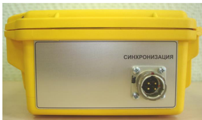
Рис. 4. Расположение разъема для подключения синхронизации на интерфейсе ТЕЛСС-ВСП.
