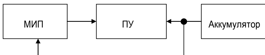
Рисунок 2 – Структурная схема магнитометра ПКМ-1М
