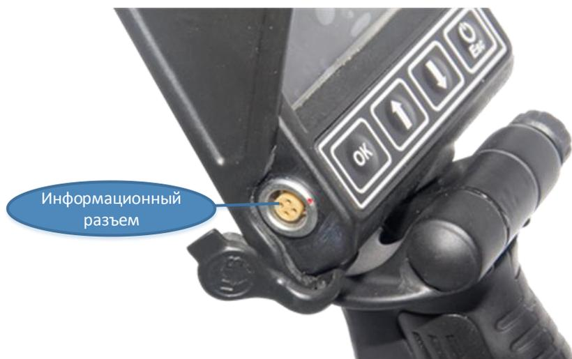
Рис. 3.15 - Разъем для подключения к ПК
