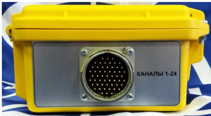
Рис. 2. Расположение разъемов для подключения сейсмических кос.
