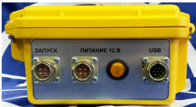
**Рис. 3. Расположение разъемов для подключения питания, синхронизации и USB.**
