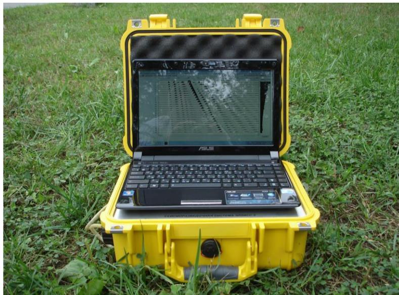
Рис. 1. Сейморазведочная система ЭЛЛИСС-3.
