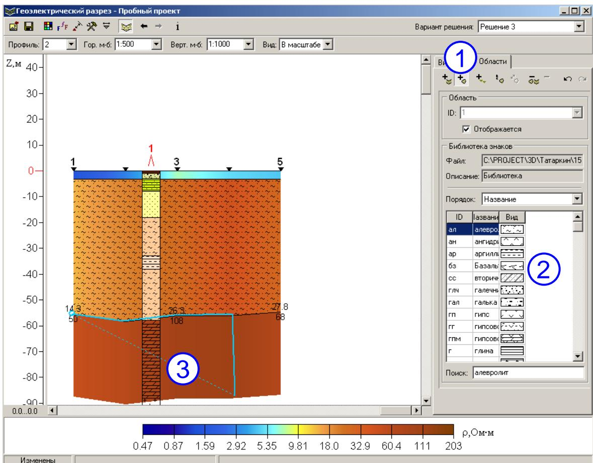
Рис. 3.44. Создание произвольных областей, залитых геологической символикой
