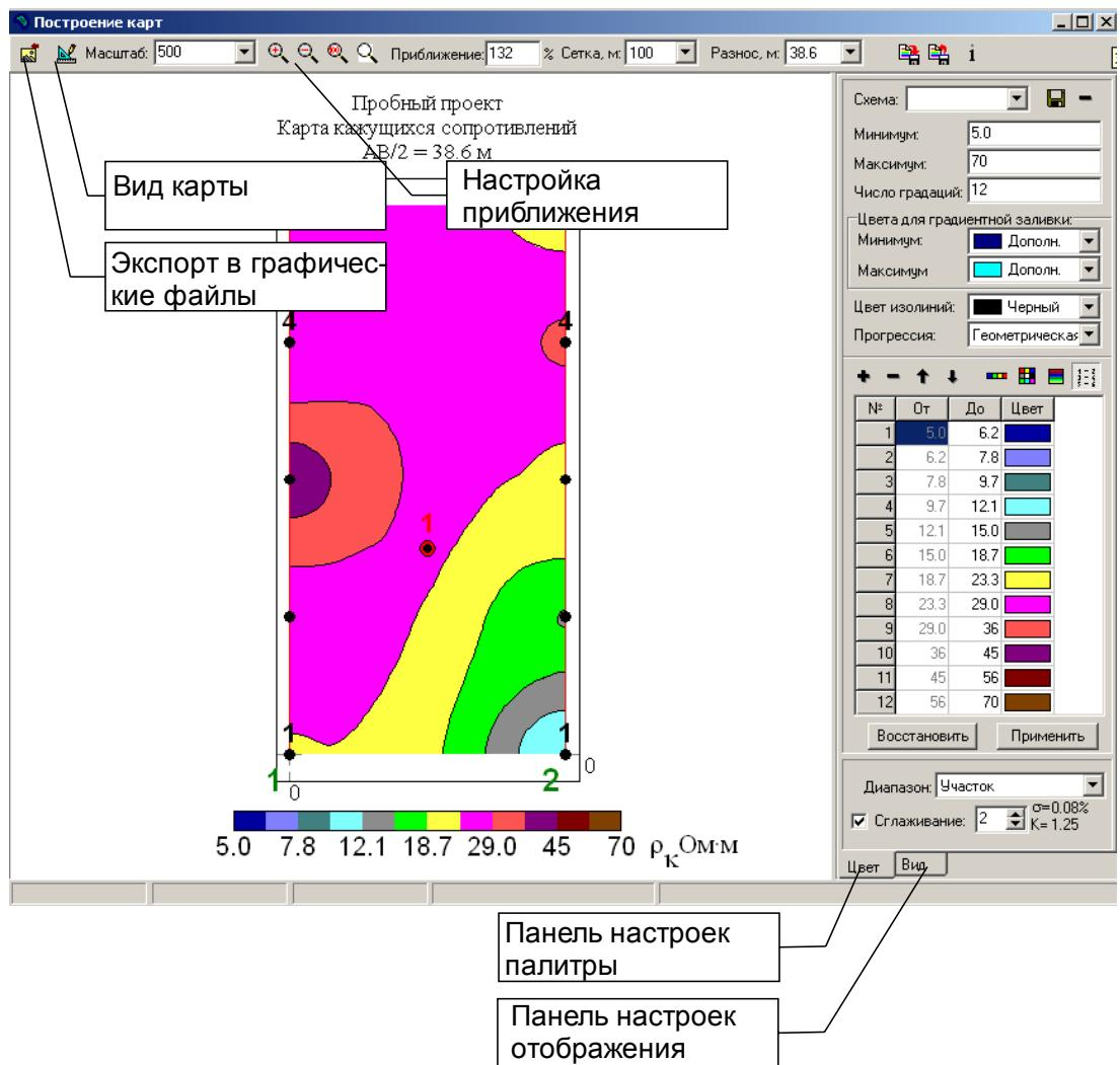
Рис. 3.23. Модуль построения карт эффективных параметров
