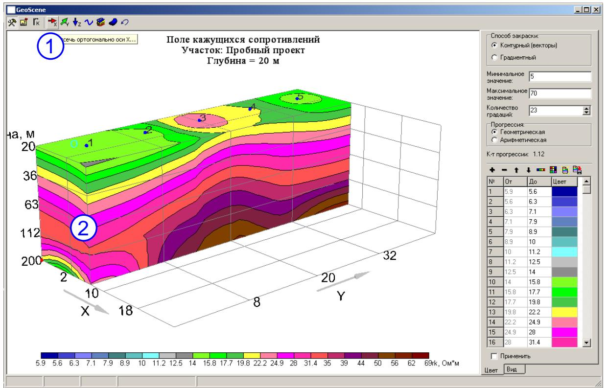
Рис. 3.27. Выполнение ортогональных срезов
