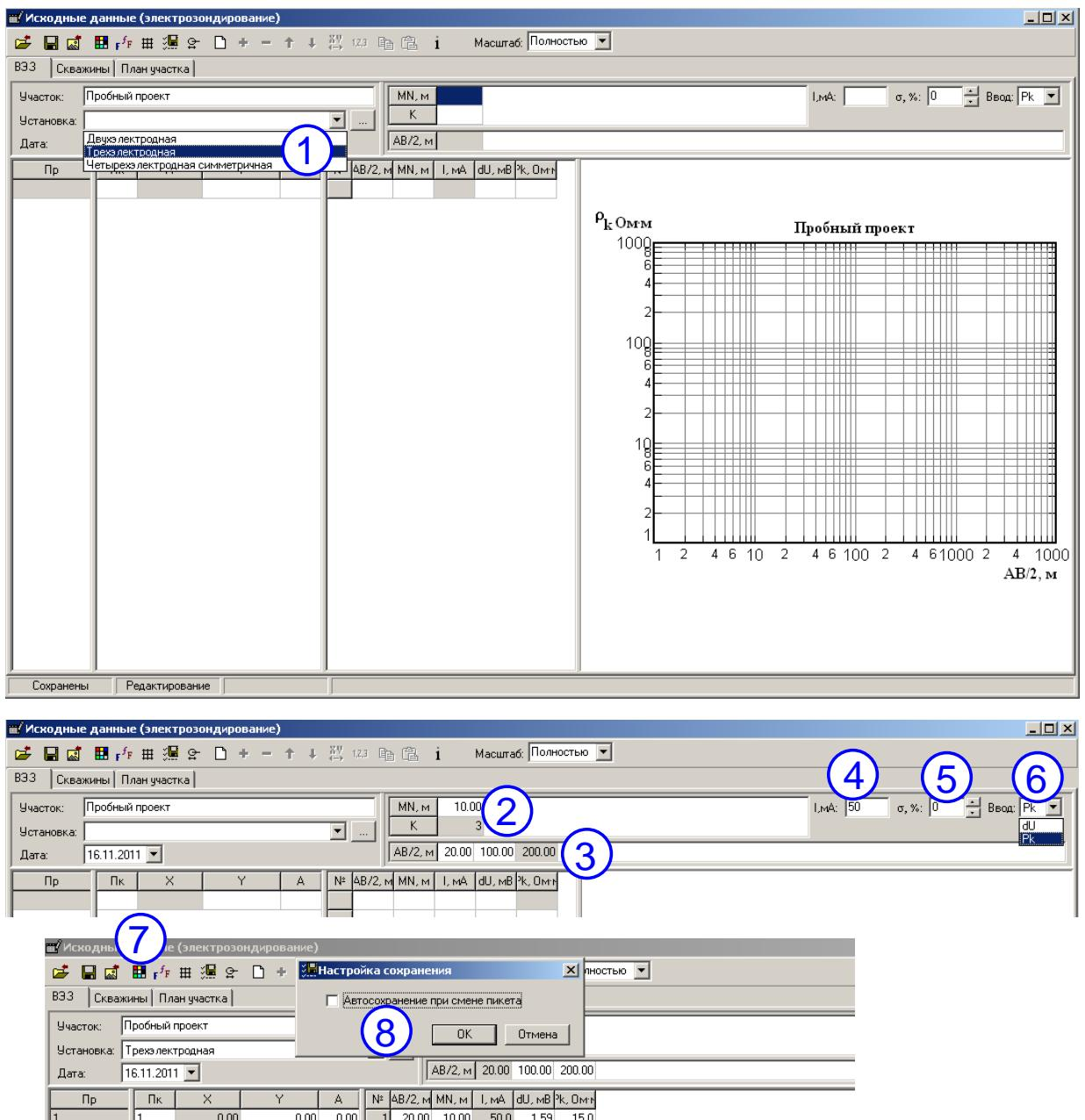
Рис. 3.15. Окно ввода и редакции исходных данных ВЭЗ, установка начальных параметров
