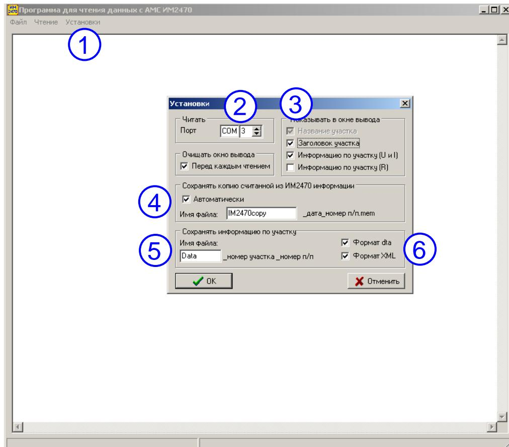
Рис. 3.6. Настройки утилиты IM2470Reading.exe
