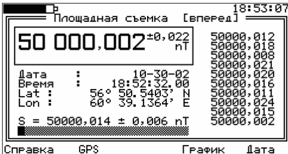
Рис. 5. Рабочее окно режима площадной съемки (GPS включен).
